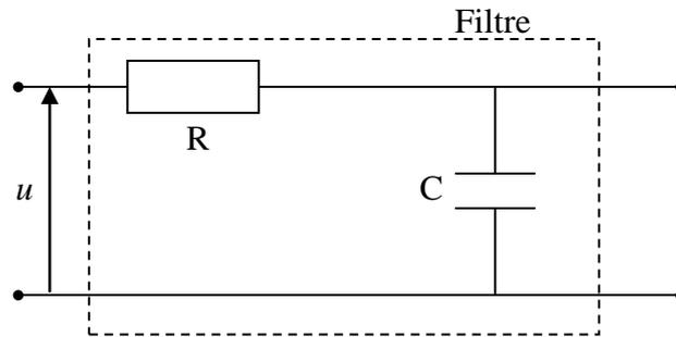
Ce filtre atténue ou « arrête » les tensions de fréquences supérieures à la fréquence
