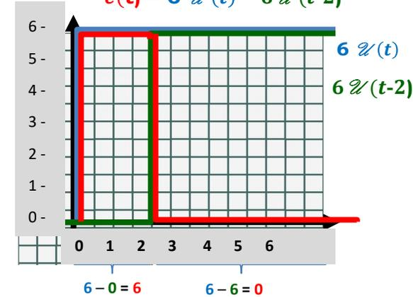
À l'instant  $t = 0$  le condensateur est déchargé et on a :  $s(0) = 0$  L'application des lois de la physique conduit, pour tout  $t \geq 0$ , à la relation :  $RC s'(t) + s(t) = e(t)$  qui s'écrit encore :  $\tau s'(t) + s(t) = e(t)$ , avec  $\tau = RC$ .
