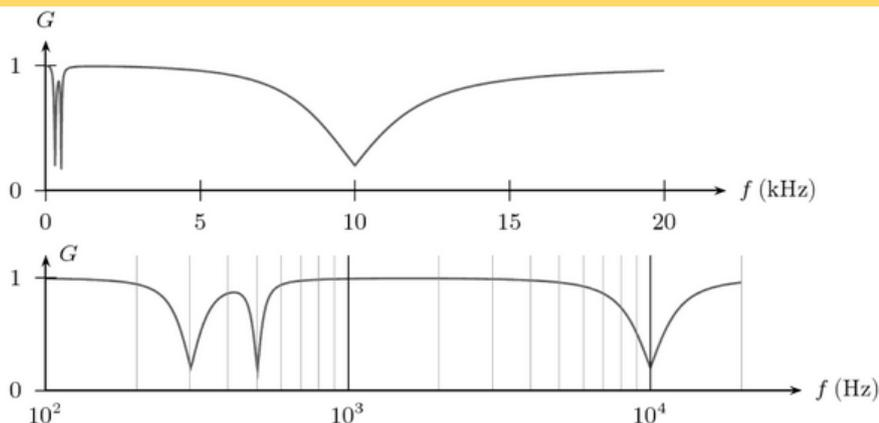
**FIG. 8.9.** Comparaison d'une même courbe de gain en échelles linéaire (en haut) et logarithmique (en bas).
